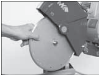
(D) Install Diamond Blade onto Blade Shaft.
