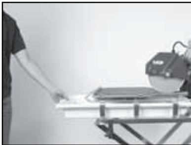
(D) Remove the Water Basin from the MK-101.
